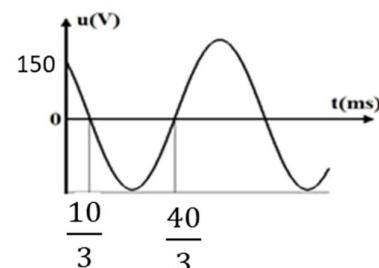
**Câu 38.** Cho đoạn mạch xoay chiều mắc nối tiếp có tính cảm kháng gồm một cuộn dây có điện trở thuần  $30\Omega$  và cảm kháng  $120\Omega$  mắc nối tiếp với tụ điện C và biến trở R. Khi giá trị của biến trở là R và  $3,5R$  thì công suất tiêu thụ trên đoạn mạch là bằng nhau và bằng  $\frac{12}{13}$  công suất cực đại khi thay đổi R. Dung kháng của tụ điện bằng
